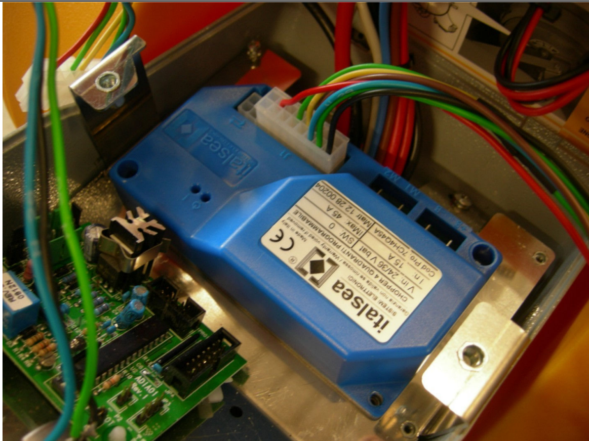
Chopper-Karte Artikelnummer 49701010 Montiert bis zur Maschinenummer 12001943
